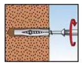
Gewicht: 0,01 kg Durchmesser: 8 mm Material: Spezialdübel
