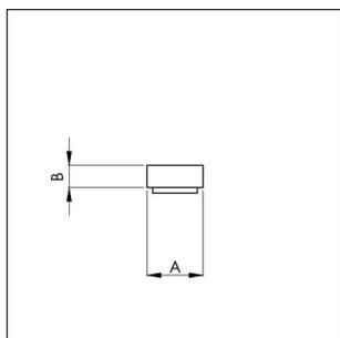
Temperaturbeständigkeit 30-+80C. Brandverhalten nach DIN 4102 Klasse B3. Schneid u. Stärketoleranzen nach DIN 7715 grob.
