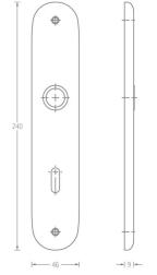
Als BB-, PZ- oder Bad-Ausführung Für Türstärken von 37 bis 42 mm Montage mit Schnellstift-Verbindung Klasse 3 nach DIN EN 1906
