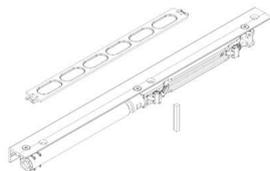
Geze Levolan 60 Softstop Set einseitig gedämpft, minimale Flügelbreite 570 mm, bis 60 kg, DIN rechts 146401
