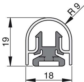
**Athmer Fingerschutzprofil BU-18K+Länge 1755mm
