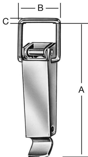
**Vormann Spannverschluss 52X23Xø3,0 RF (V2A)**
