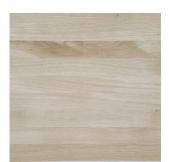
Leimholzplatten sind einlagige Massivholzplatten, deren Holzleisten über die Schmalseiten verleimt werden. Die Leimholzplatte zeichnet sich durch ihre hohe Festigkeit in Faserrichtung aus
