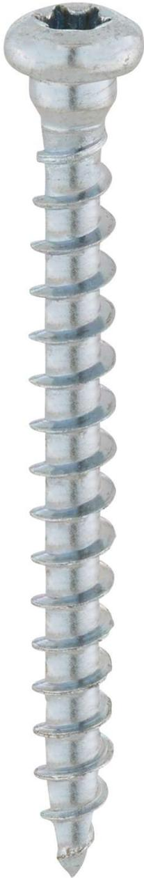
Spax Holzverbinderschraube SXCS 5,0x35mm Wirox A9J T20 Vollgewinde mit spezieller Unterkopfgeometrie passend für alle Holzverbinder mit 5,0mm
