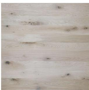
Leimholzplatten sind einlagige Massivholzplatten, deren Holzleisten über die Schmalseiten verleimt werden. Die Leimholzplatte zeichnet sich durch ihre hohe Festigkeit in Faserrichtung aus
