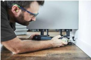
Mit dem Tiefenanschlag lässt sich eine genaue Eintauchtiefe einstellen und somit das Sägeblatt schützen - noch bevor es auf Stein oder Beton trifft. Der Gleitschuh ist mit dem Kreissägeblatt eine große Hilfe beim Führen auf ebenen Flächen mit genauer Schnitttiefe.
