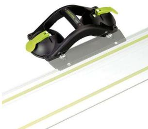
Der GECKO DOSH ist ein klassischer Doppelsaugheber und wird verwendet um Werkstücke mit geschlossenporigen Oberflächen wie zum Beispiel Glasplatten zu tragen. Das besondere am GECKO ist aber, dass er in Verbindung mit dem Adapter DOSH-FSAD die Führungsschiene an Ort und Stelle hält. Vor allem dort wo keine Schraubzwingen angesetzt werden können, wie zum Beispiel in der Mitte großer Platten oder auf Fliesenböden.
