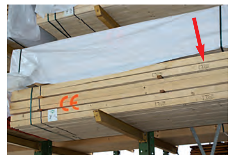
Abb. 4: Das CE-Zeichen ist eine gute Hilfe, maßgeblich ist jedoch die CE-Kennzeichnung (Pfeil)
