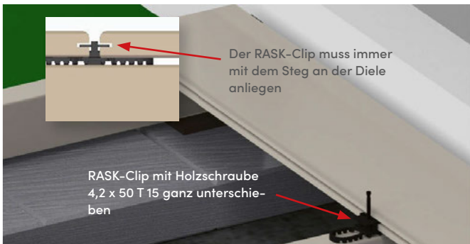
Bild 23. Schieben Sie den RASK-Clip soweit unter die Diele, dass der RASK-Clip mit dem Steg komplett anliegt. Danach können Sie den Start-Clip fest runterdrücken und die Diele ist fixiert. Die Schrauben dürfen noch nicht festgeschraubt werden, sondern erst wenn die nächste Diele ausgerichtet ist.
