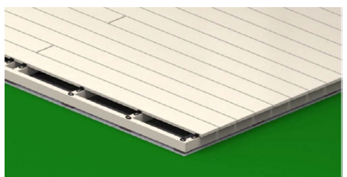
Bild 32. Die vorderste Terrassendielle sollte wenn möglich ca. 10 mm über die vordere Unterkonstruktion überstehen. Die Befestigung ist nicht mit dem RASK-Clip möglich, sondern sollte mit Terrassenschrauben und Teilstücken vom RASK-Clip erfolgen. Sie können diese Unterlegstücke einfach vom RASK-Clip abbrechen.
