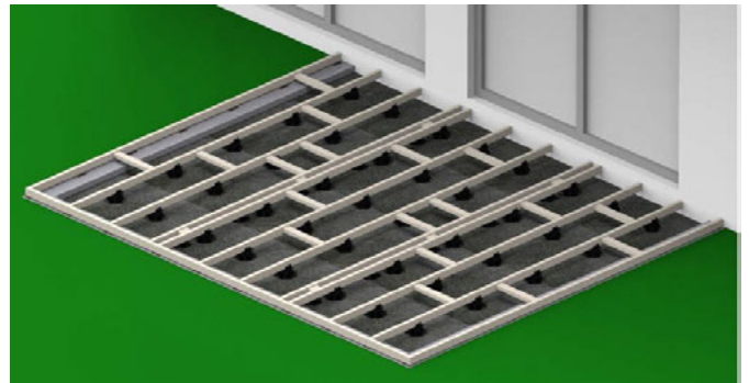
Bild 13. Wenn alle Unterkonstruktionen und Verstellfüße montiert sind, kann die komplette Rahmenkonstruktion ausgerichtet werden.
