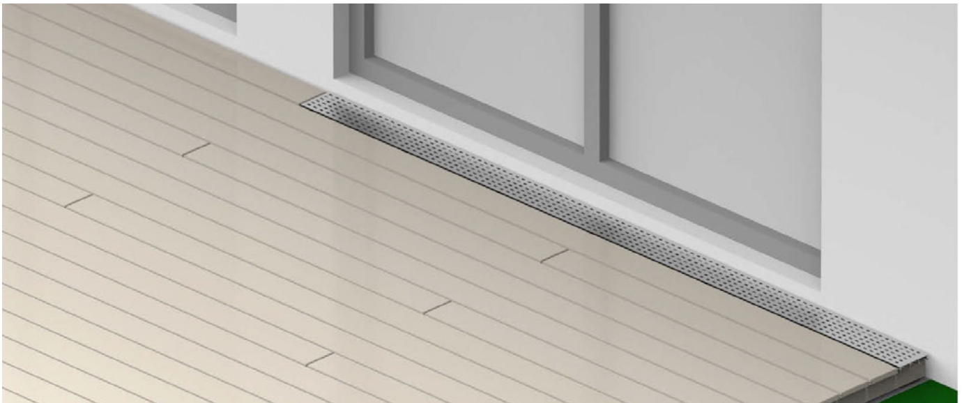
Bild 15. Nach den Regelwerken muss immer ein z. B. Entwässerungsrast eingebaut werden, wenn kein Höhenunterschied von 150 mm eingehalten werden kann.
