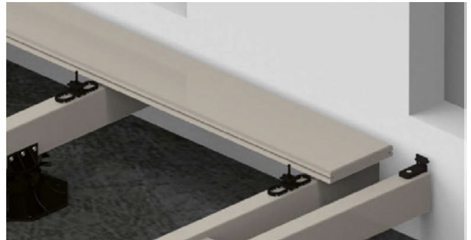
Bild 22. Die Dielenenden sollten an den Längsstößen ca. 30 mm überstehen und an der Rasenkantenseite ca. 10-20 mm.
