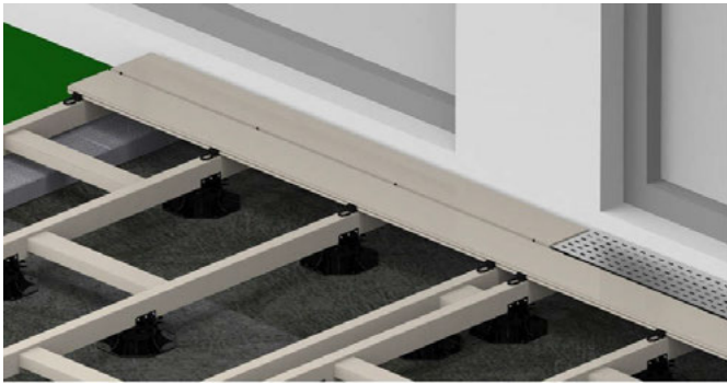
Bild 27. Wenn die erste Terrassendielle und das Drainageprofil so fixiert und eingebaut wurden, kann die 2. Dielenreihe auf die RASK-Clips geschoben werden. Schieben Sie dann die nächsten RASK-Clips unter die 2. Diele und drehen die Holzschrauben 4,2 x 50 mm (T 15) nur soweit ein, dass der RASK-Clip nicht mehr verrutschen kann.
