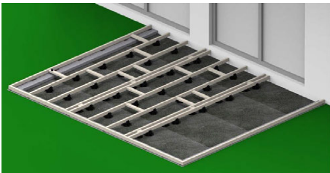
Bild 12. Montieren Sie alle weiteren Unterkonstruktionsbalken inkl. der benötigten Verstellfüße als ausgesteifte Rahmenkonstruktion.
