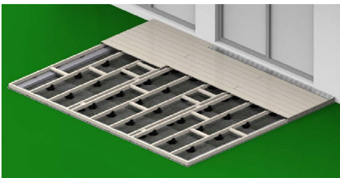
Bild 31. Verlegen Sie die weiteren Terrassendielen auf der gesamten Fläche nach den vorherigen Schritten und prüfen Sie zwischendurch ob die Abstände zur Hauswand gleich sind, ggf. muss nachkorrigiert werden, damit die vordere Diele gleichmäßig breit geschnitten werden kann.
