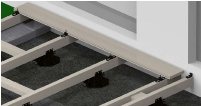
Bild 21. Stecken Sie die erste Terrassendiele auf die Start-Clips und schieben auf der anderen genuteten Seite der Terrassendiele die Kebony RASK-Clipse unter die Diele.
