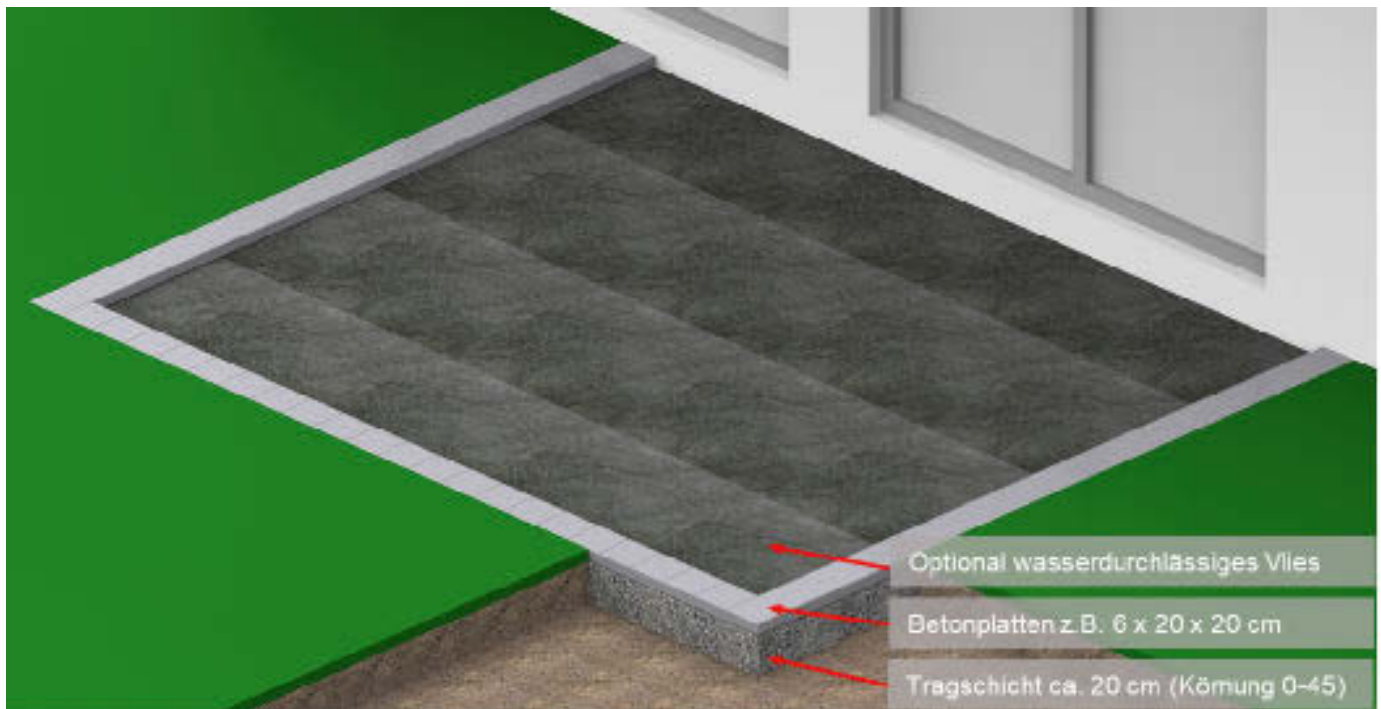
Bild 5. Bei der Verwendung von Verstellfüßen statt Betonplatten, kann auf die Bettungsschnitt verzichtet werden. Bei Verwendung eines dunklen bzw. schwarzen Unkrautvlieses fallen die Verstellfüße in den Fugen nicht mehr so auf. Das Unkrautvlies muss wasserdurchlässig sein und sollte ca. 10 cm überlappen.
