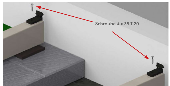
Bild 18. Der Startclip wird mit den Schrauben 4 x 35 mm (T 20) auf die Holzunterkonstruktion geschraubt. Bei Verwendung einer Aluminium-Unterkonstruktion muss die Schraube 4,2 x 19 mm (T 20) verwendet werden.
