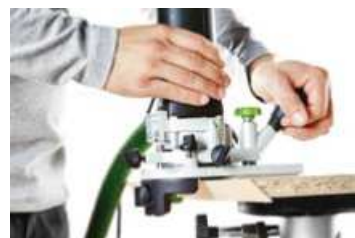
Radien anfräsen oder planfräsen mit Modul-Kantenfräse MFK 700 B
