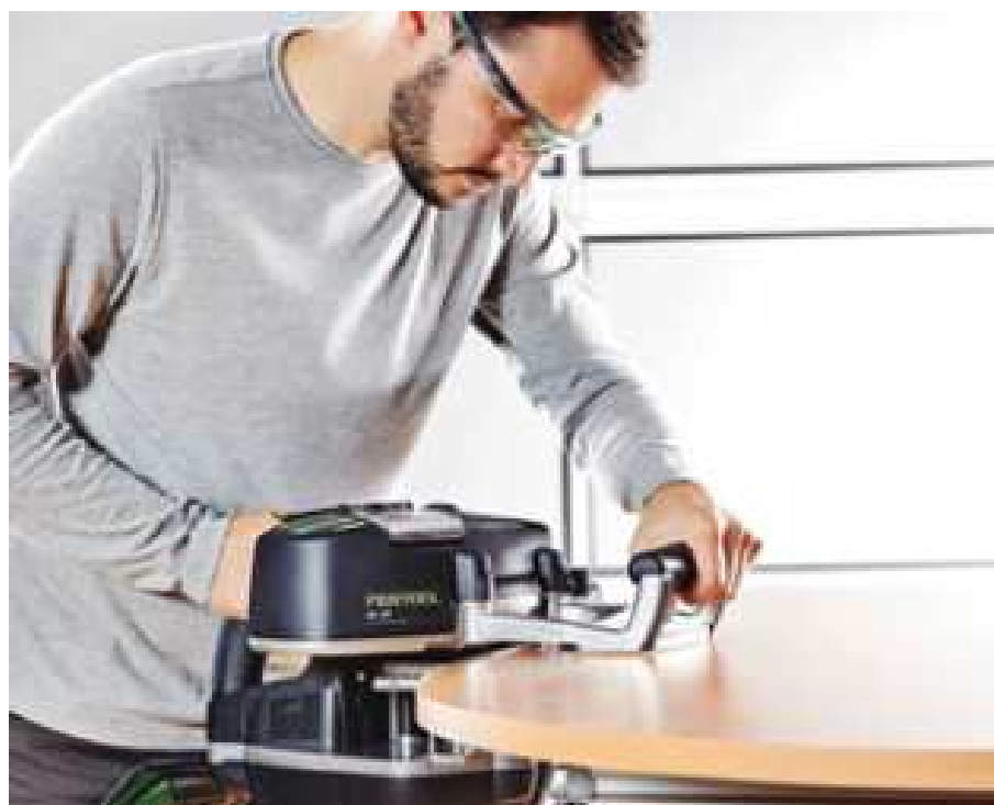
Radien anfräsen oder planfräsen mit Modul-Kantenfräse MFK 700 B
