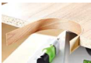
Innenradius bis 50 mm, min. Außenradius von 25 – 30 mm
