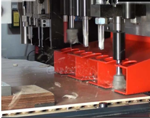
Bohren und Fräsen auf einem Bearbeitungszentrum
