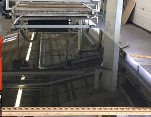
Beschichtung mit Rollenware auf einer Kalanderpresse
