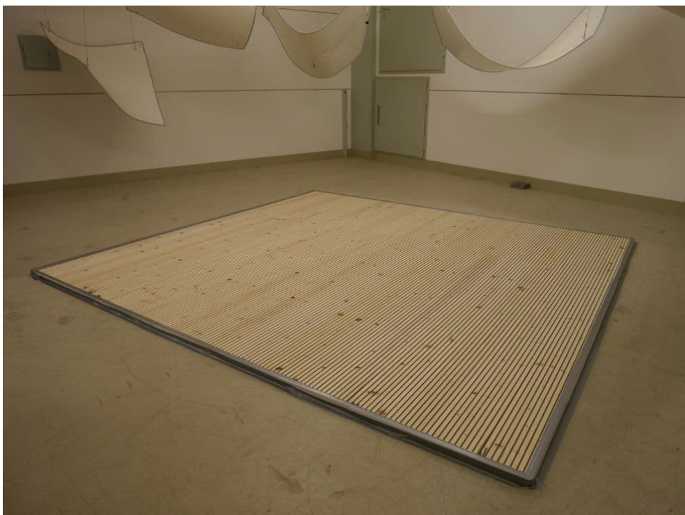
Abbildung B.4. Aufbau Nr. 1 (Typ A, direkt montiert): Gesamtansicht des prüffertigen Prüfaufbaus.
