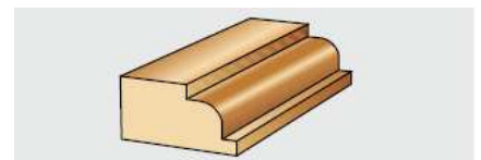
Mit Kugellager \varnothing 9,5 mm zum Stabfräsen.
