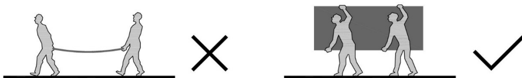
Abbildung 1.2 – Handhabung der Valchromat-Platten
