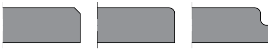
Abbildung 1.8 – Maschinelle Bearbeitung der Kanten. Fase, Abrundung und Fräsbearbeitung
