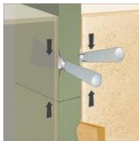
Bild 2: Stumpfstoß im Massivbau
