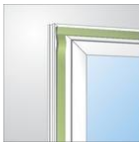
Bild 1: Eckauslegung bei der Fenstermontage
